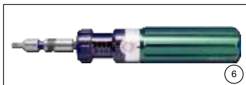
(图 6) 扭力扳手配有： • PZ型套筒，2号规格，适用于M4螺丝 • 六角套筒，4号规格，适用于M5螺丝 • 六角套筒，5号规格，适用于M6螺丝
